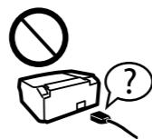
Należy używać tylko przewodu zasilającego dostarczonego z drukarką. Użycie innego przewodu może spowodować pożar lub porażenie prądem. Nie wolno podłączać tego przewodu do innych urządzeń.
