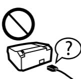
Należy używać tylko przewodu zasilającego dostarczonego z drukarką. Użycie innego przewodu może spowodować pożar lub porażenie pradem. Nie wolno podłączać tego przewodu do innych urządzeń. Používejte pouze napájecí kabel dodaný s tiskárnou. Použití jiného kabelu může způsobit požár nebo úraz elektrickým proudem. Napájecí kabel nepoužívejte s žádným jiným zařízením.
