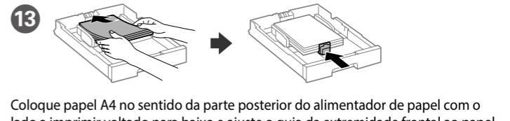
Coloque papel A4 no sentido da parte posterior do alimentador de papel com o lado a imprimir voltado para baixo e ajuste o guia da extremidade frontal ao papel.
